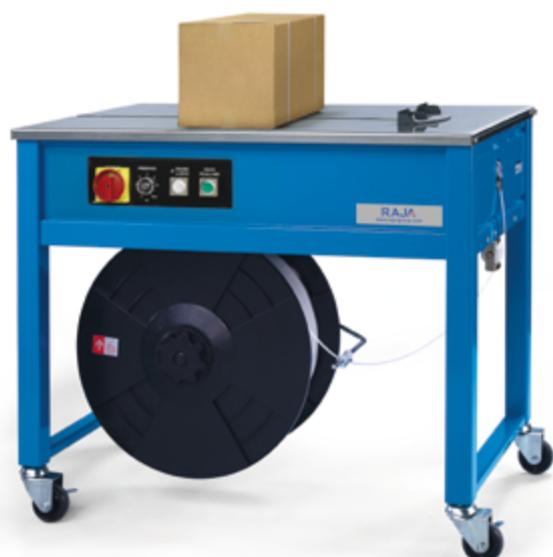
Un choix idéal pour cercler des colis de manière constante. Il suffit à l'opérateur de passer le feuilard autour du colis. Le serrage, la soudure et la coupe du feuilard se réalisent ensuite automatiquement en moins de 2 secondes. Ces machines permettent d'économiser de l'énergie et peuvent être facilement déplacées grâce aux roulettes.
